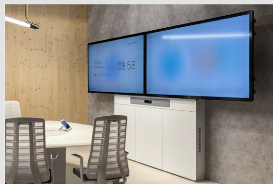
W8 XL², wandmontiert mit Cisco Room Kit Plus in individueller VC-Blende.
